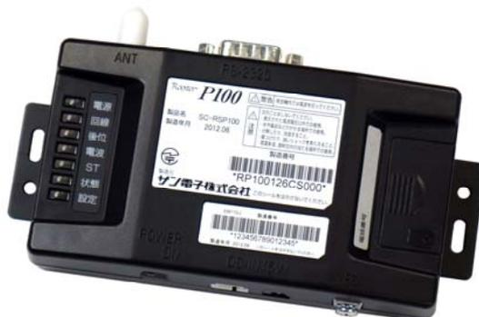
「Rooster-P100(仮称)」は、ファーウェイ社製のモジュールを搭載、RS-232C のインターフェイスを実装、プロトコル変換機能を持ち、後位端末から AT コマンドを制御することで、後位端末にて PPP を実装することなく、IP によるモバイルネットワークへのアクセスが可能です。搭載モジュールは NTTドコモ FOMA 網でサービス提供している MVNO 事業者でも利用が可能で、これまでに培った技術を活かして制御機能や、遠隔からの FW アップロード機能、ログ情報の保存機能など、組み込みで無人運用を想定した特徴をもっております。
