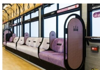
バケットシートと、通路幅を広くするスタンションポール
