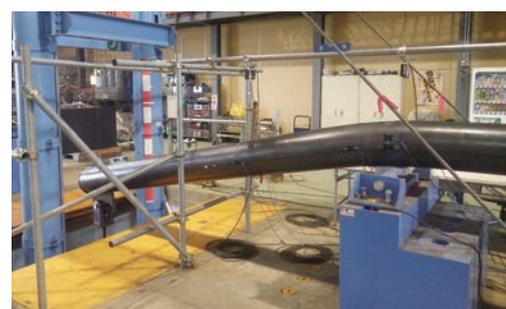
静的荷重載荷実験状況
