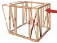
一般的な在来工法 (筋交い補強)
