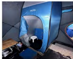
循環型シャワーシステム
