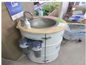
水循環型手洗いスタンド (志賀町)
