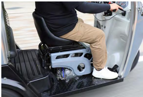
新設計のフレームは 250cc エンジンに対応。サイドアルミフレームは 250cc モデルの振動に耐える肉厚に変更し強度を確保。また、従来のスイングアーム式から 3 リンク式リジッドアクスルサスペンションへ変更する事で強度及び操縦安定性を向上。
