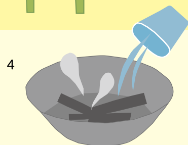
4 竹が炭化してきたら、水をかけて火を消す
