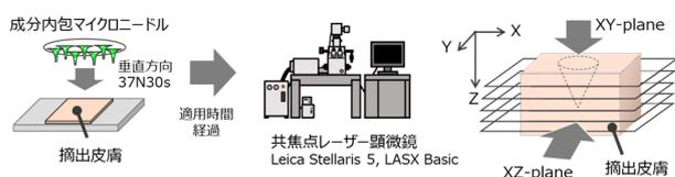
図 3 共焦点レーザー顕微鏡による 3D 可視化の手法
