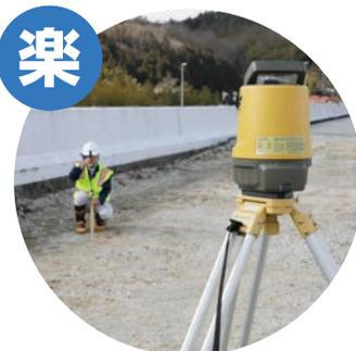
3. 「クイナビ ケッテイ」の音声コマンドで簡単に実測値が記録できます。次の杭打ち点に自動的に旋回するラクラク作業です。
